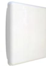
Lettori di prossimità a lunga portata UHF per applicazioni veicolari con lettura fino a 10 metri in area libera. La frequenza di lettura tarabile da 840 a 960 MHz interroga i transponder passivi applicati al parabrezza del veicolo. Ogni lettore viene fornito con staffa di supporto per l'installazione su palo. Elevato grado di protezione per installazione da esterno (IP65).
