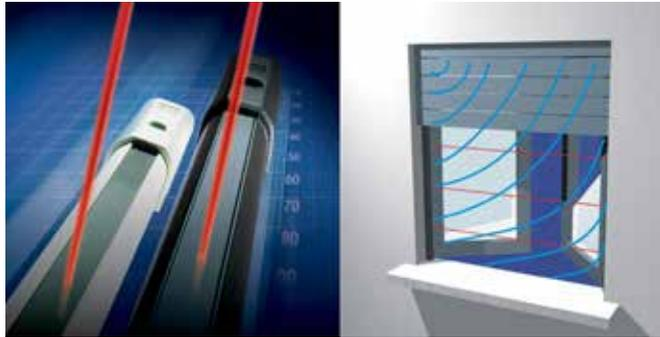
Barriere a doppia tecnologia composte da infrarossi attivi e mini doppler con portate di 3 e 6 m in esterno. Dimensioni 22,5 X 23 mm. Dotata di tamper antistrappo. Funzione anti-insetto. Diagnostica di puntamento ottico. Installazione a muro. Plug & Play. Struttura completamente in alluminio di colore NERO. Attenzione: gli ingombri effettivi risultano essere 80mm oltre la lunghezza indicata
