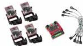
Set 4 ottiche ibride 100 m, circuito di elaborazione, termostato, riscaldatore, disqualifica, strumento audio visivo incorporato, 4 canali. (Kit per composizione in colonna.)
