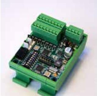
Scheda Master a 8 relè (4 per zone + 4 per allarmi tecnici generali) Espandibile fino a 20 relè di zona + 4 relè tecnici. Allarmi su relè con contatto libero via RS-485 fino a 1,2km. Note: Aggiungere 2 schede slave SIOUX-CARD-8S per ottenere massima espansione disponibile a 20 zone per Controller.
