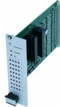
Modulo seriale in formato 3U con 32 uscite relays per remotizzazione di tutti gli stati di allarme per 8 barriere/dispositivi.
