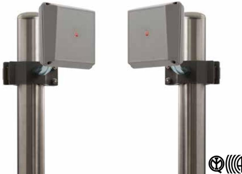
Barriera a microonde analogica con antenna parabolica. Quattro canali di codifica. Consumo 200 mA (TX+RX). Alimentata a 13,8 Vdc. Uscite separate per intrusione e manomissione.
