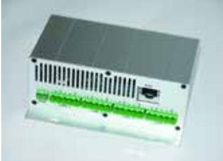
Ripetitore/Convertitore di linea 5 porte RS 485, 1 porta Ethernet, 1 porta RS 232, contenitore di alluminio
