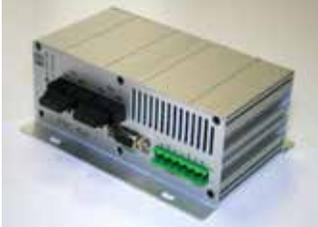
Ripetitore/Convertitore di linea 5 porte RS 485, 2 porte Fibra Ottica Mono-Modale, 1 porta RS 232, contenitore di alluminio.
