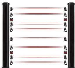
Set di ottiche da esterno ad infrarossi attivi "ibridi" 100 Hz per portate di 50, 100 e 200m senza cavo di sincronismo. Ogni ottica è sia TX che RX. Lista esemplificativa per una barriera h. 2m con 8 fasci IR portata 100m: TOWER HT2 (oppure TOWER-DM2) = Pz. 2, TOWER BASE = Pz. 2, NEWTONPLUS4100 = Pz. 4, POWER-KIT = Pz. 2, NEWTONFLAT = Pz. 1
