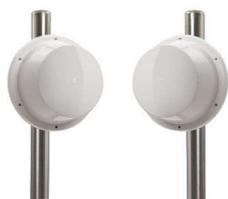
Barriera a microonde analogica con antenna parabolica. Quattro canali di codifica. Consumo 200 mA (TX+RX). Alimentata a 13,8 Vdc. Uscite separate per intrusione e manomissione.
