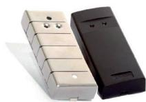
eXprox, lettore di prossimità TDSi compatibile con tecnologia EM4100 ed EM4102 a 125KHz. In materiale plastico ABS, viene fornito con cover nera e bianca; adatto ad installazioni in interno ed esterno. Portata di lettura sino a 15 cm con tessere passive formato ISO, sino a 7 cm con TAG passivi. Uscita Wiegand o Clock&Data, 2 LED di segnalazione, buzzer integrato.
