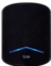
Gardis, lettore di prossimità TDSi, compatibile con tecnologia ISO 14443-A standard Mifare Plus e Desfire a 13,56 MHz. In materiale plastico ABS di colore nero; adatto ad installazioni in interno ed esterno. Portata di lettura fino a 10 cm con tessere passive formato ISO. Uscita Magnetic stripe o Wiegand 26 bit/34 bit/37 bit, 1 LED di segnalazione RGB, buzzer integrato.
