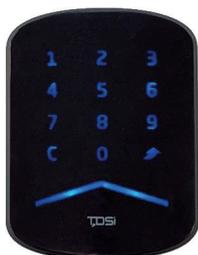
Gardis, lettore di prossimità TDSi completo di tastiera numerica retro-illuminata, compatibile con tecnologia EM4100, EM4102 ed EM4200 a 125KHz. In materiale plastico ABS di colore nero; adatto ad installazioni in interno ed esterno. Portata di lettura fino a 10 cm con tessere passive formato ISO. Uscita Magnetic stripe o Wiegand 26 bit/34 bit/37 bit, 1 LED di segnalazione RGB, buzzer integrato.
