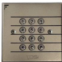
EXprox2VR, lettore di prossimità TDSi completo di tastiera numerica retro-illuminata, compatibile con tecnologia EM4100 ed EM4102 a 125KHz. Versione Antivandalica in acciaio inox; adatto ad installazioni in interno ed esterno. Portata di lettura sino a 15 cm con tessere passive formato ISO, sino a 7 cm con TAG passivi. Uscita Wiegand o Clock&Data, 2 LED di segnalazione, buzzer integrato.
