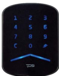
Gardis, lettore di prossimità TDSi completo di tastiera numerica retro-illuminata, compatibile con tecnologia ISO 14443-A standard Mifare Classic a 13,56 MHz. In materiale plastico ABS di colore nero; adatto ad installazioni in interno ed esterno. Portata di lettura fino a 10 cm con tessere passive formato ISO. Uscita Magnetic stripe o Wiegand 26 bit/34 bit/37 bit, 1 LED di segnalazione RGB, buzzer integrato.
