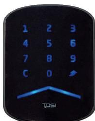
Gardis, lettore di prossimità TDSi completo di tastiera numerica retro-illuminata, compatibile con tecnologia ISO 14443-A standard Mifare Plus a 13,56 MHz. In materiale plastico ABS di colore nero; adatto ad installazioni in interno ed esterno. Portata di lettura fino a 10 cm con tessere passive formato ISO. Uscita Magnetic stripe o Wiegand 26 bit/34 bit/37 bit, 1 LED di segnalazione RGB, buzzer integrato.
