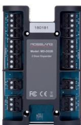
Scheda di espansione a 8 ingressi supervisionati e 4 uscite a relè per applicazioni di sicurezza, collegabile al sistema di controllo accessi AC-425IP-B, può essere installato direttamente all'interno dello stesso utilizzando l'alimentatore mod- ME-1515-E. Collegato al sistema direttamente al controllore.
