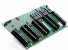
Scheda di espansione Ex in/out a 32 ingressi supervisionati e 16 uscite a relè per applicazioni di sicurezza, collegabile al sistema di controllo accessi Expert tramite BUS RS 485. 32 ingressi supervisionati e 16 uscite a relè da 30 V 2 A.
