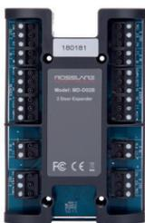
Scheda di espansione a 2 porte per il sistema di controllo accessi AC-225IP-B, può essere installato direttamente all'interno dello stesso utilizzando l'alimentatore mod- ME-1515-E. Collegato al sistema direttamente al controllore. La scheda di espansione supporta due lettori Wiegand o Clock & Data con 4 uscite liberamente programmabili a relè da 5 A e 4 ingressi.
