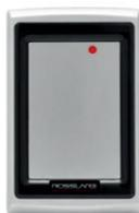
Lettore di prossimità AY-Q12C in versione antivandalica, compatibile con tecnologia EM4102 a 125KHz. In acciaio inox, adatto per installazioni in interno ed esterno. Portata di lettura fino a 10 cm con tessere passive formato ISO. Uscita Wiegand 26-Bit, RS-232 o Clock&Data, multi LED tricolore di segnalazione stato e buzzer integrato.
