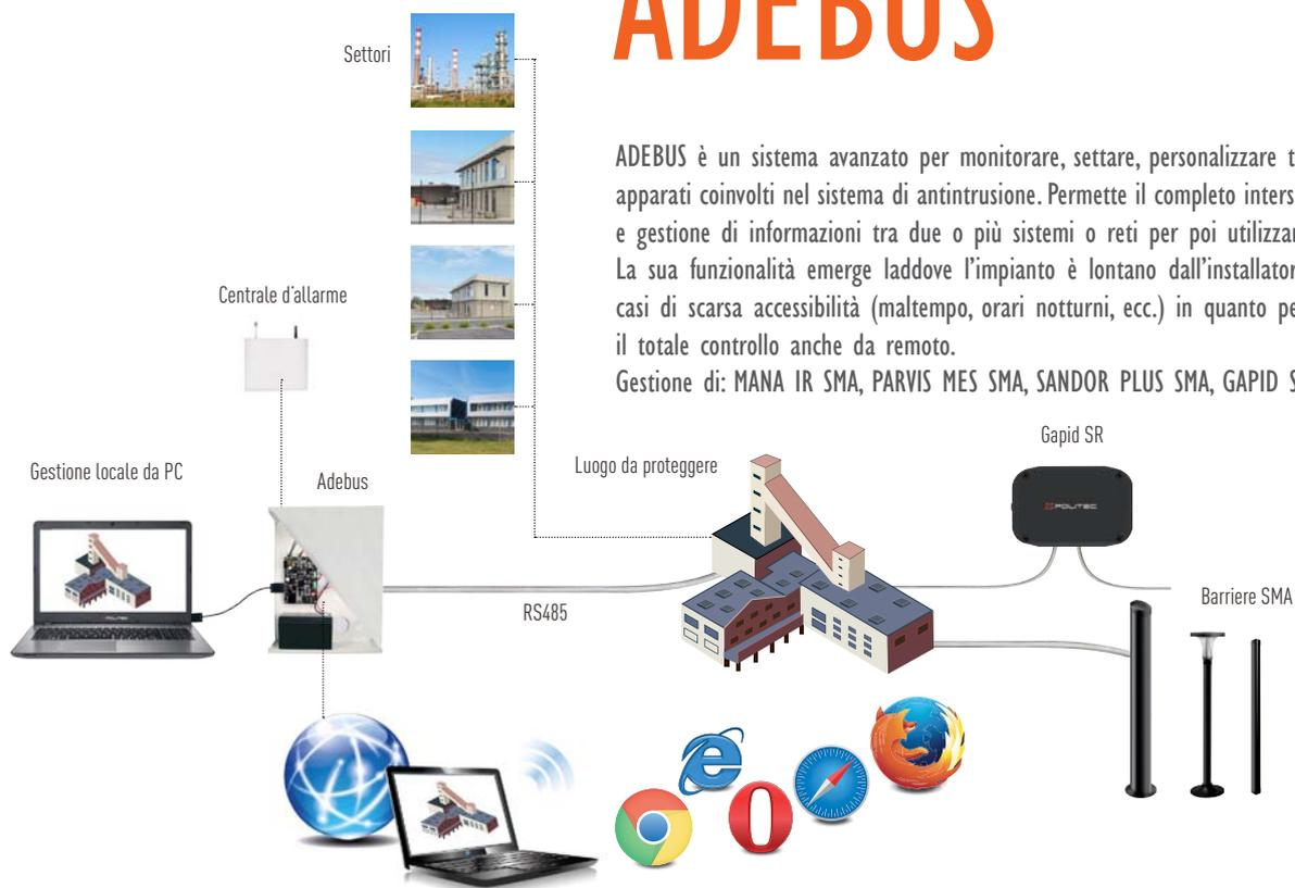
ADEBUS è un sistema avanzato per monitorare, settare, personalizzare tutti gli apparati coinvolti nel sistema di antintrusione. Permette il completo interscambio e gestione di informazioni tra due o più sistemi o reti per poi utilizzarle. La sua funzionalità emerge laddove l'impianto è lontano dall'installatore o in casi di scarsa accessibilità (maltempo, orari notturni, ecc.) in quanto permette il totale controllo anche da remoto.
