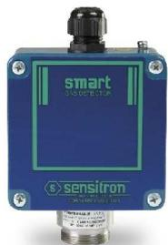
I rivelatori di gas serie **SMART3G-C3** vengono impiegati per rivelare, in aree classificate Zona 2, la presenza di sostanze infiammabili (% LIE), di gas tossici in ppm, gas refrigeranti oppure per la rivelazione di deficienza o eccesso di ossigeno.
