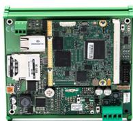
Centrale per controllo accessi. Ogni centrale gestisce da 4, 8 o 32 varchi (a seconda del modello), 100.000 codici e 32.000 eventi in modalità off-line (senza il PC collegato) ampliabili a richiesta. Disponibile su richiesta software di controllo accessi gratuito KS-CF/4-v4. L'alloggiamento su guida  $\Omega$  ed i cablaggi su morsetti estraibili velocizzano l'installazione e la manutenzione.
