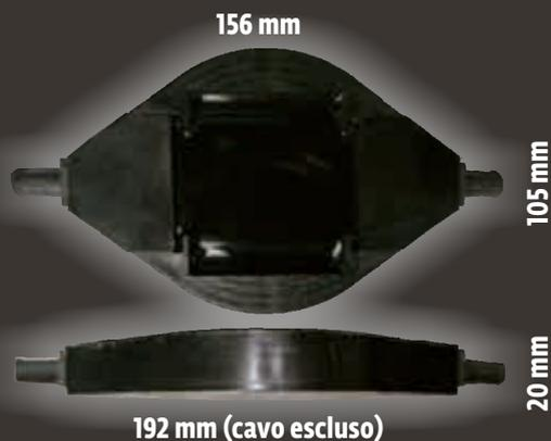
Sensore d'allarme interrato direttamente nel terreno (ad una profondità di 40/60 cm) o sotto cemento (prof. max 30 cm), con rilevatore di pressione mediante sensore piezodinamico, fornito in linee precablate standard o personalizzate (max 70 sensori) con distanza consigliata tra i sensori 70 cm. È l'ideale per una protezione perimetrale invisibile e di conseguenza non eludibile.
