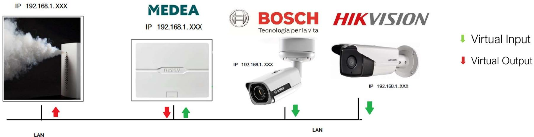
Nell'esempio riportato , a fronte di allarme generato da una telecamera IP ( es . Attraversamento linea ) attraverso il sistema Medea può essere comandato l'innescò di un nebbiogeno IP.
